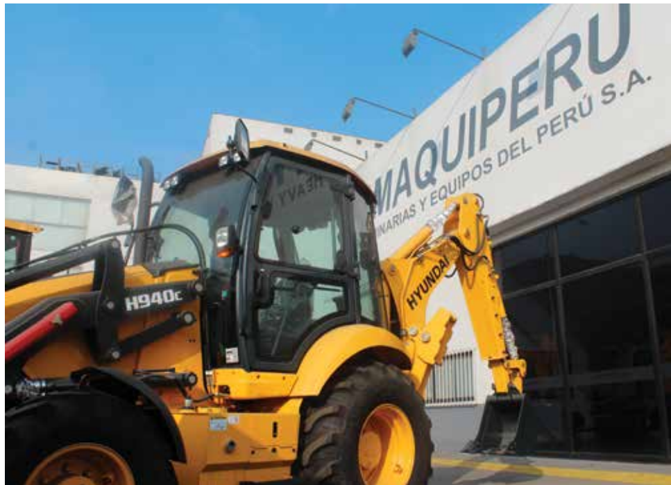
La retroexcavadora en minería, modelo H940C tiene 1.0 m3 de capacidad de cuchara en el cargador.
