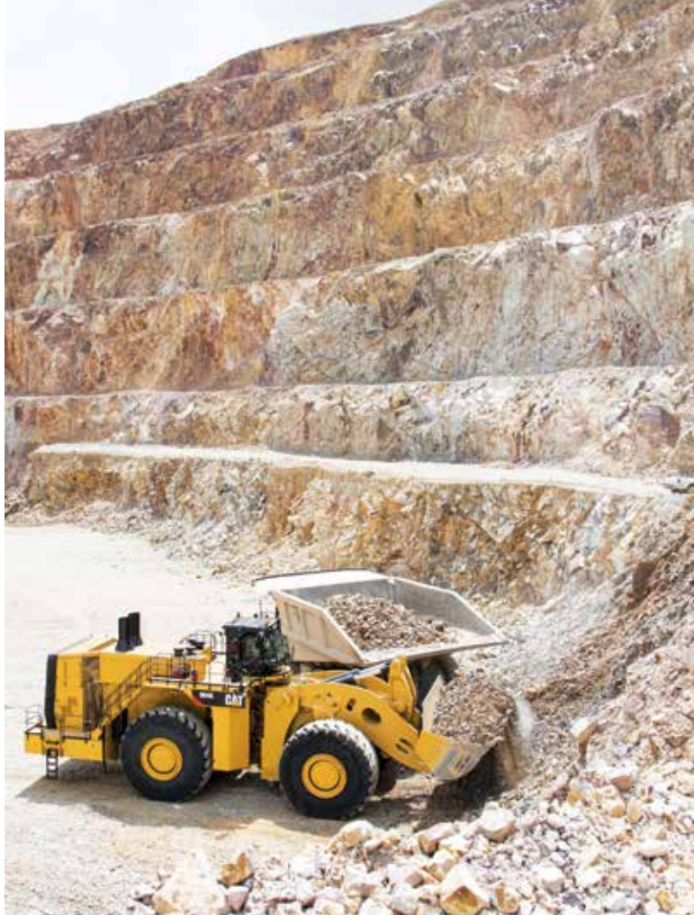
Los cargadores frontales se dedican a labores de carguío, abasteciendo de material a los equipos de acarreo.
