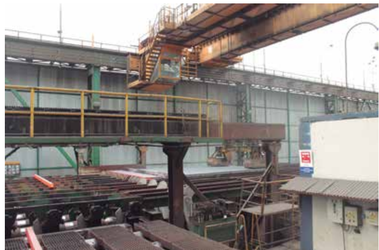
La palanquilla, producto final de la Acería, es transportada por separadores magnéticos.
