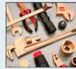
Herramientas aisladas y anti chispas
