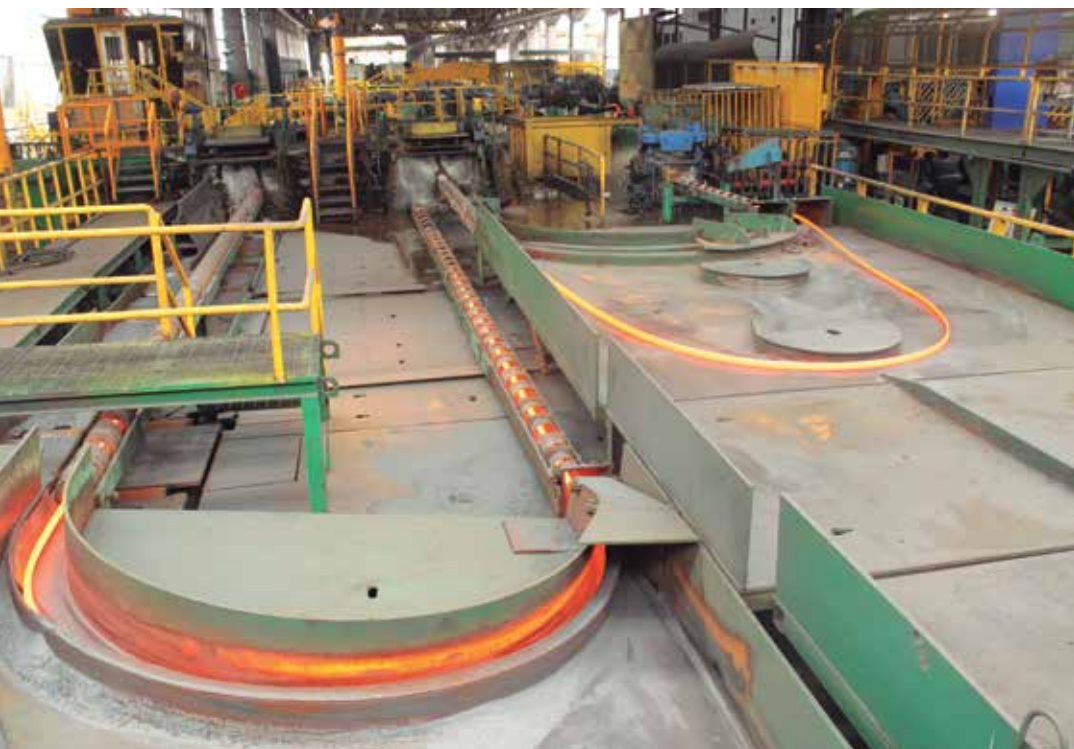
En el área de Laminación, la palanquilla es recalentada a 1,200 grados.
