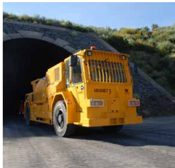
Las dimensiones del Mixkret 3 son 1.970 mm de ancho y 2.250 mm de alto.
