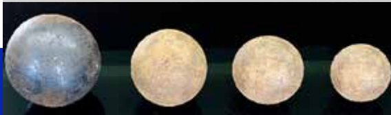
PATRÓN DE DESGASTE DE LAS BOLAS FF-4
