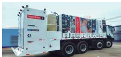
Camión lubricador Soltrak 8x4 de servicio pesado, con volumen de 4000 galones y sistemas de grasa de alta presión, alto caudal y sistema de filtración. Diseñado para operaciones de gran minería.
