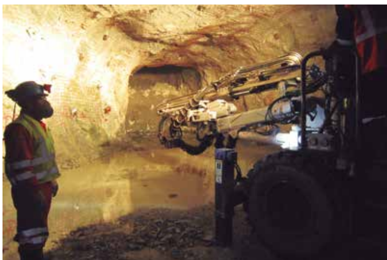
De acuerdo a Furukawa Rock Drill, en minería subterránea se utiliza mucho la jumbo de perforación "frontonero".
