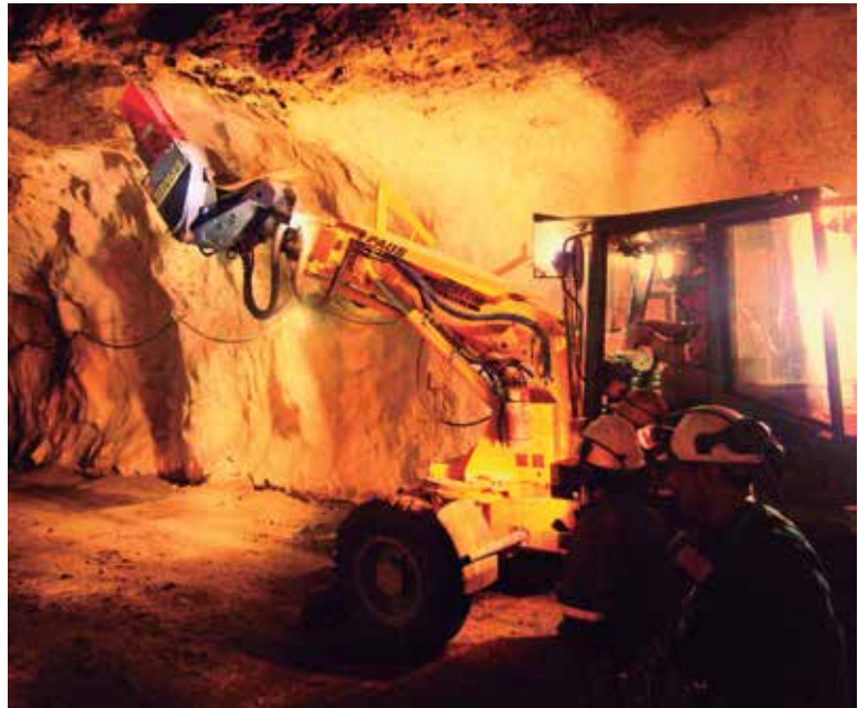
Entre los desatadores de roca Paus de Ferreyros destaca el modelo 853-S8, que tiene un martillo hidráulico con alcance de 7.7 metros.
