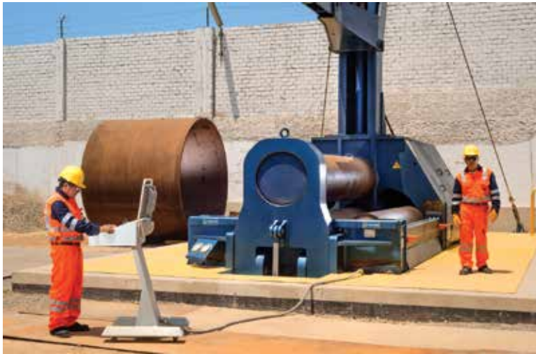
Roladora CNC de 4 rodillos la más grande del Perú.
