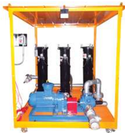
Módulo de Transferencia de Combustible y Filtrado para un Caudal Promedio de 250 GPM
