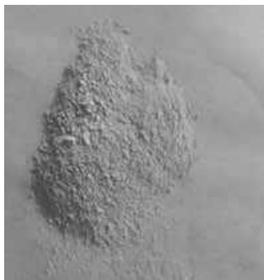
Foto 3: Precipitado seco de hidróxido de zinc
