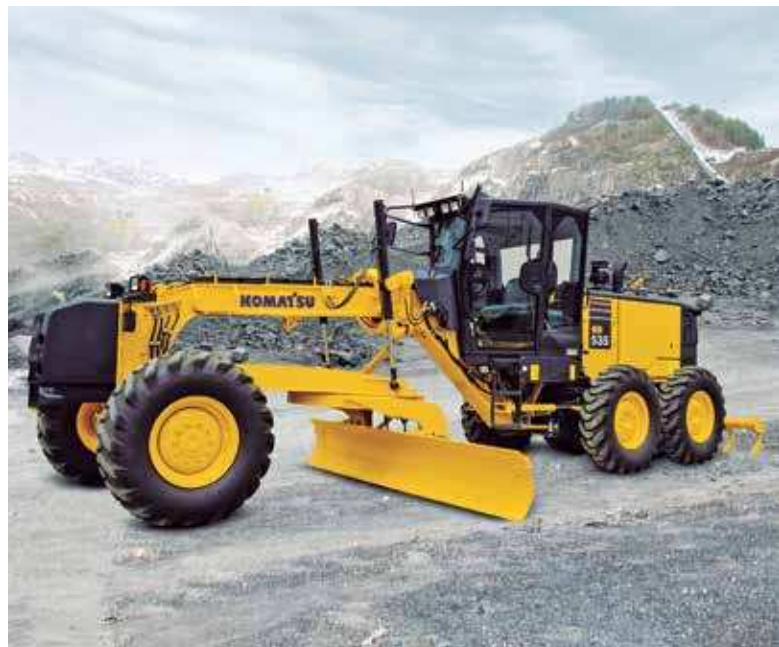
En el 2018, ingresó al mercado el modelo GD535-5, un equipo versátil para trabajos de infraestructura vial y operaciones que requieran una hoja de 12 pies.
