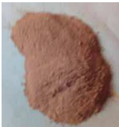
Foto 2: Precipitado seco de hierro.
