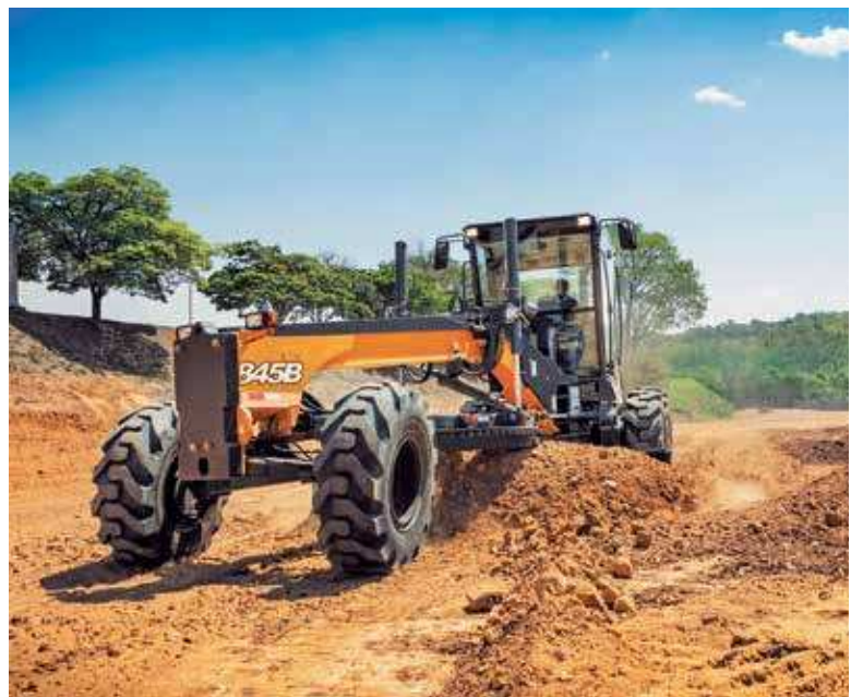
La motoniveladora cuenta con un diseño que permite total visibilidad en trabajos con ripper y fácil acceso a los componentes internos.
